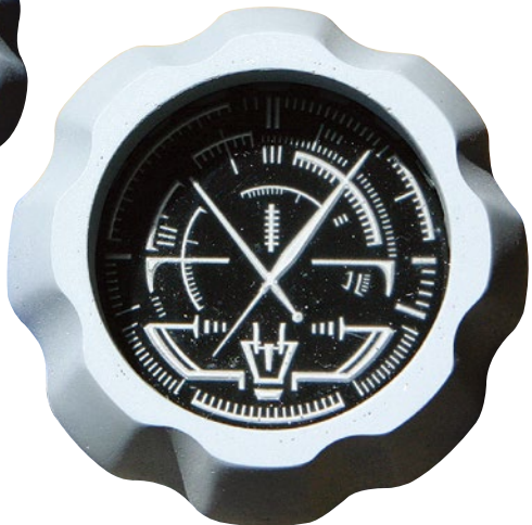
文字盤原型 作図した白黒画像を印刷用樹脂版 「トレリーフ」に転写して凸凹原 版を作成。透明レジンで複製し、 凹部分に白塗料、裏側からお好み の色を塗ってレリーフ状の文字盤 を製作。セルの色塗りと同じなの で、均一な色面が可能。
