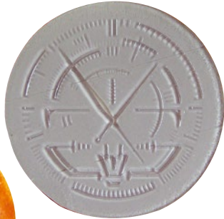
文字盤原型 作図した白黒画像を印刷用樹脂版 「トレリーフ」に転写して凸凹原 版を作成。透明レジンで複製し、 凹部分に白塗料、裏側からお好み の色を塗ってレリーフ状の文字盤 を製作。セルの色塗りと同じなの で、均一な色面が可能。
