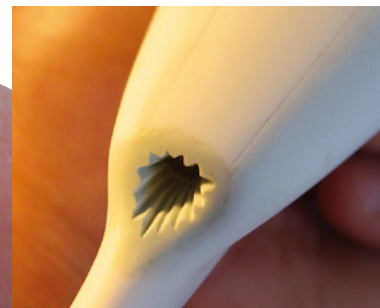
めかりのない下地作り 型抜けが悪く、へたれたスリット部分もエッジの効いた仕上がりに。全パーツに渡っての調整が本機の完成度に貢献している。
